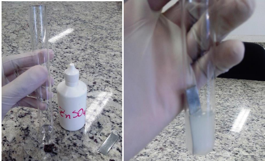
Figura 16: Reação da solução de ZnSO 4 com metal.
