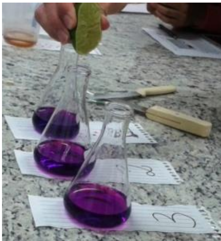
Figuras 07: O limão como agente redutor e o permanganato como agente oxidante.
